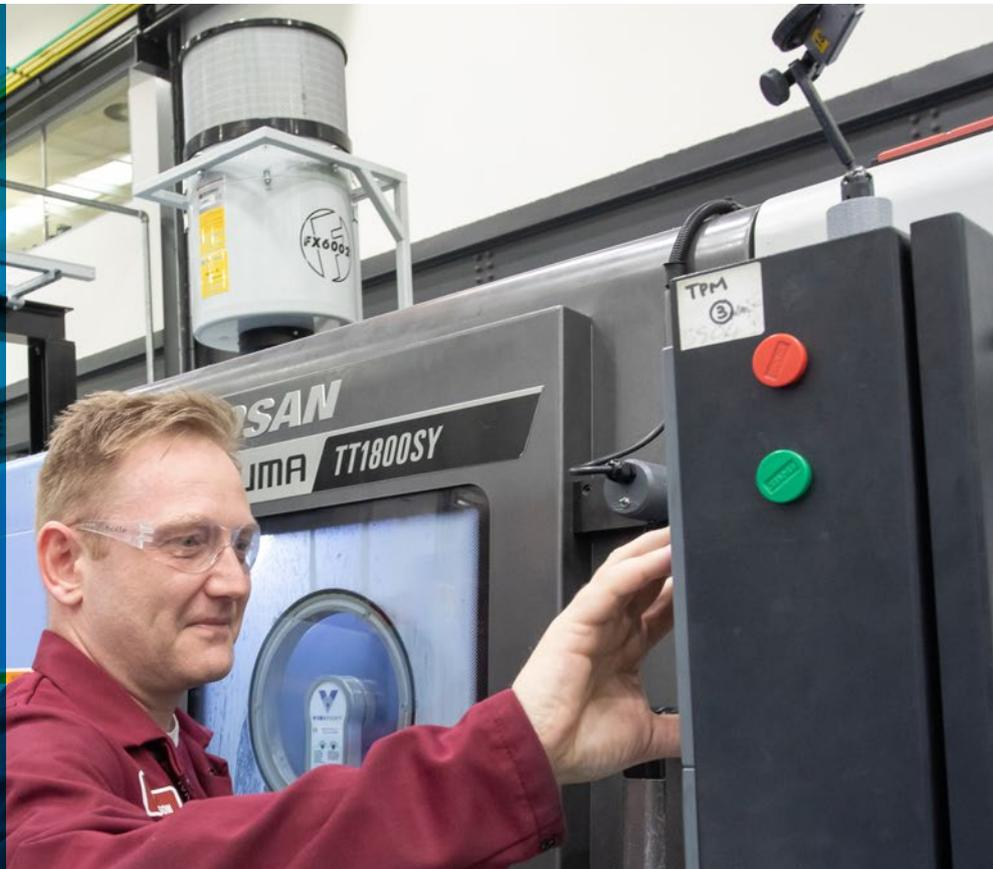
L'**F Monitor Essential** misura che il flusso d'aria tra la macchina e l'unità sia sempre corretto. Un semplice sistema a semaforo permette all'operatore di verificarne costantemente l'efficienza.
